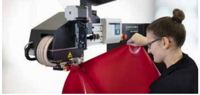
Tecnología innovadora de la cuña de soldadura
