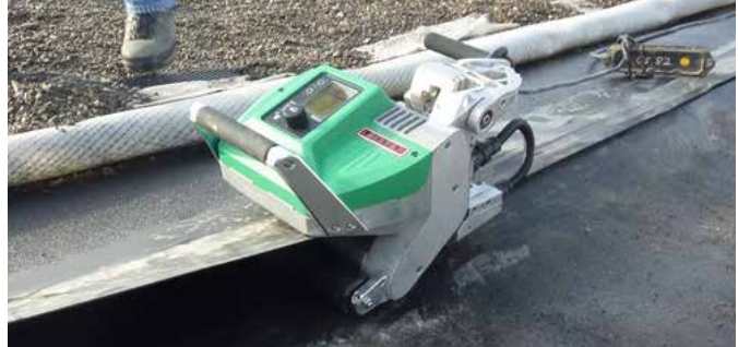
En la prueba de campo (Sudáfrica) el GEOSTAR soldó 240 m en un solo turno de trabajo sin ningún problema
