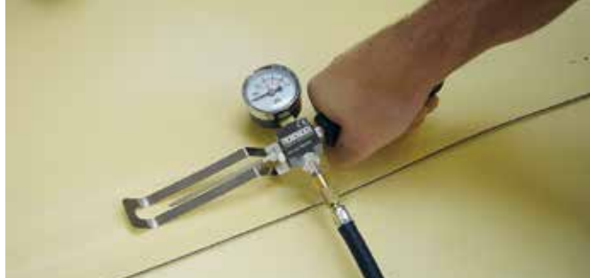
Comprobación de la estanqueidad de costuras solapadas con canal de prueba.
