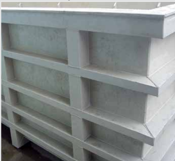
Galvanoplastia tanque, Turquía. Material: PP
